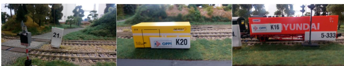
Fig. 3 RFID anténa a umístění RFID tagů na modelové železnici Zdroj: [ 4.]
