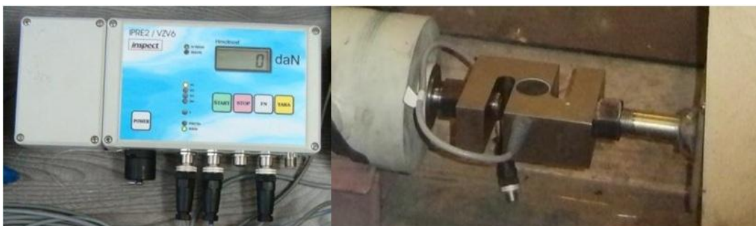
Obr. 3 Meracia elektronika IPRE2/VZV 6 s napojením na PC a silomer Tedeo-Hutleigh 619 - 5000 daN s presnosťou <0,1% z maximálneho zaťaženia nosnosti
