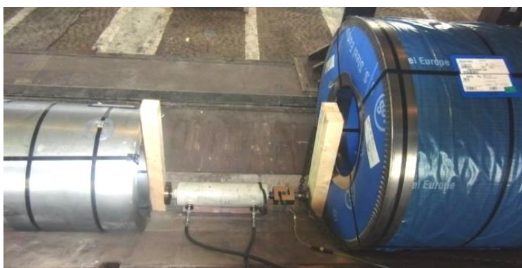
Obr. 4 Umiestnenie piesta so silomerom počas merania
