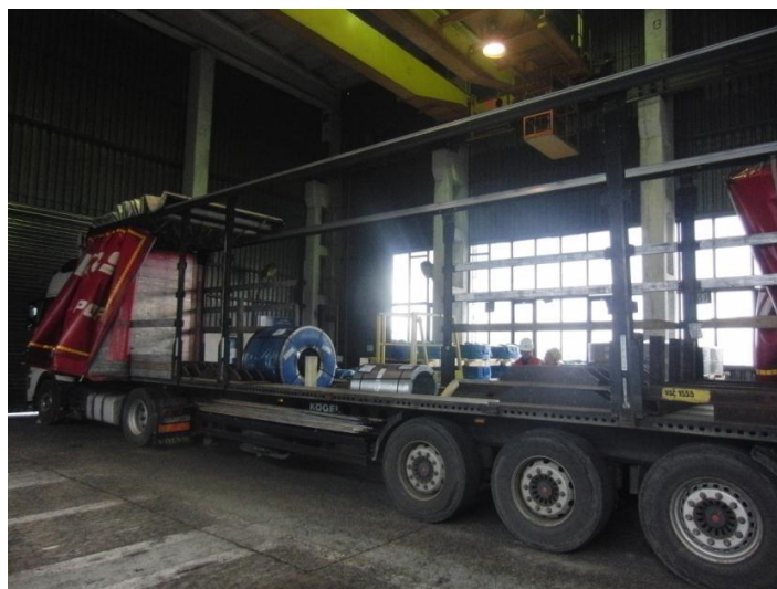
Obr. 5 Náves KOGEL Light Maxx použitý pri skúškach súčiniteľov trenia zvitok - žľab návesu
