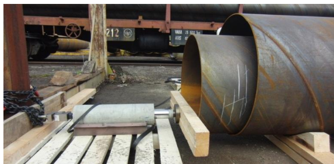
Obr.6 Umiestnenie piesta so silomerom počas merania súčiniteľov trenia vkladných rúr[9]
