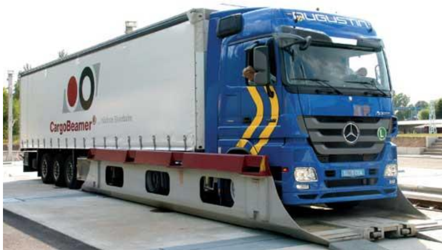
Obr 1 Nakládka kamionu do vozu CargoBeamer
