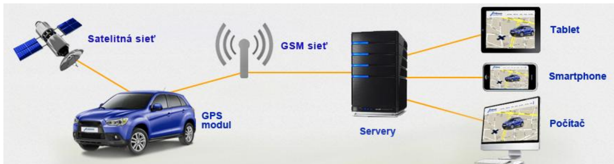
Obr. 2 Princíp fungovania on-line GPS monitoringu
