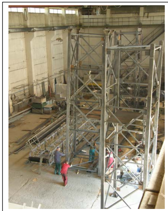
Obr. 4 Výroba nôh cementačných síl
