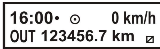
Obr. 4 Zobrazenie displeja pri režime OUT
