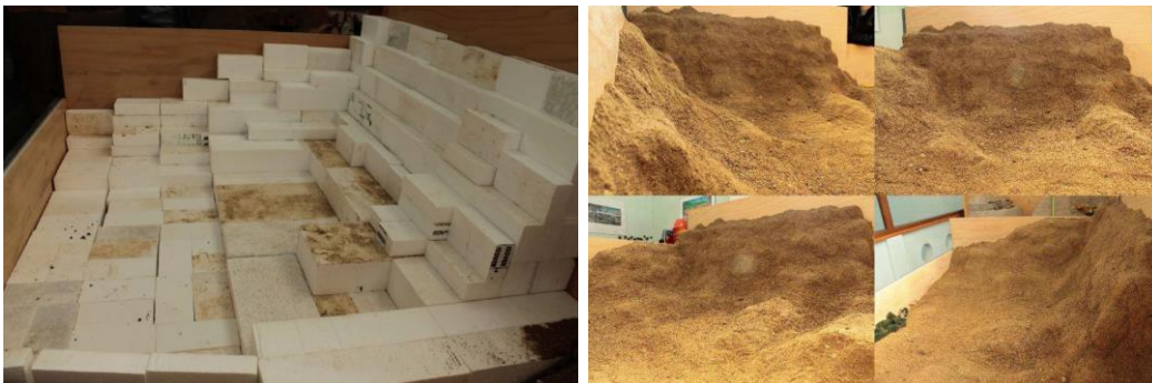
obr. 6 Nosný skelet modelu – vľavo; Skelet modelu lomu pokrytý OPAKOMATOM - vpravo [4]
