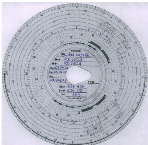
Obr. 3 Záznamové listy a tachografová karta vodiča
