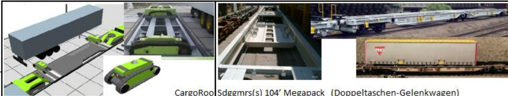
CargoRoof Sdggmrs(s) 104' Megapack (Doppeltaschen-Gelenkwagen)
