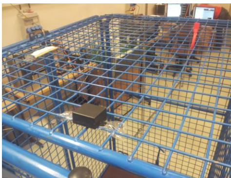
Obrázok 10. Umiestnenie RFID identifikátorov (Zdroj: [5])
