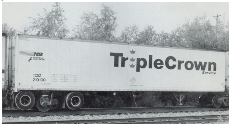
Obr 2 Původní typ návěsu RoadRailer s integrovaným železničním dvojkolím Zdroj: Triple Crown RoadRailer Project
