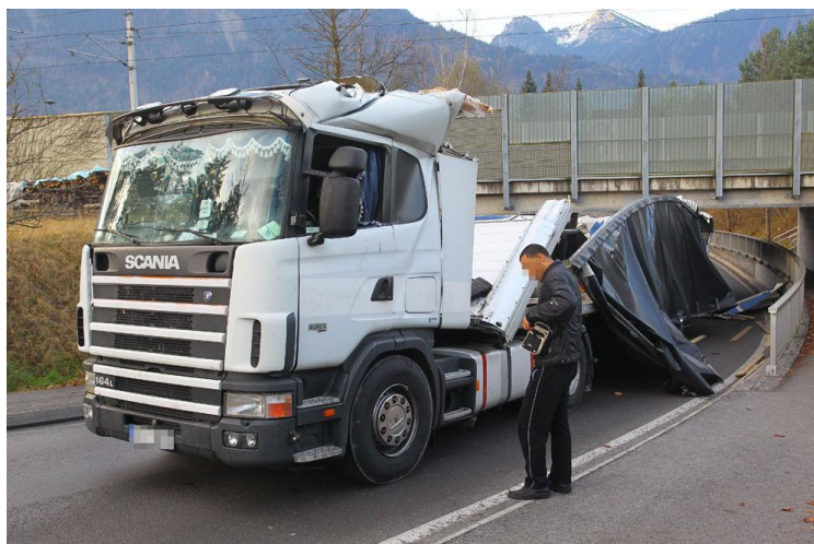
Obr. 1: Následky zle vybratej trasy vzhľadom na výšku súpravy
