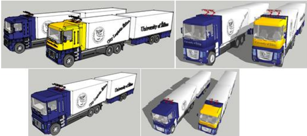
Obr. 4 - Konceptia nákladných vozidiel so zberačmi pre trakčné vedenie trolejbusového vedenia Zdroj: [1]
