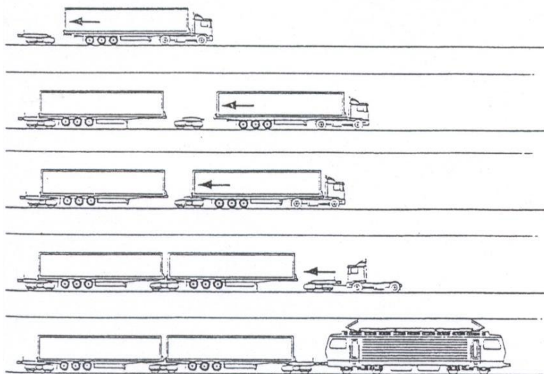
Obr 1 Technologický postup při sestavě vlaku z podvojných návěsů Zdroj: www.wiwi.uni-frankfurt.de
