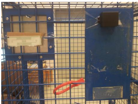
Obrázok 7. Umiestnenie RFID identifikátorov (Zdroj: [5])
