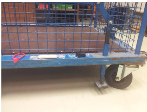
Obrázok 12. Umiestnenie RFID identifikátorov (Zdroj: [5])
