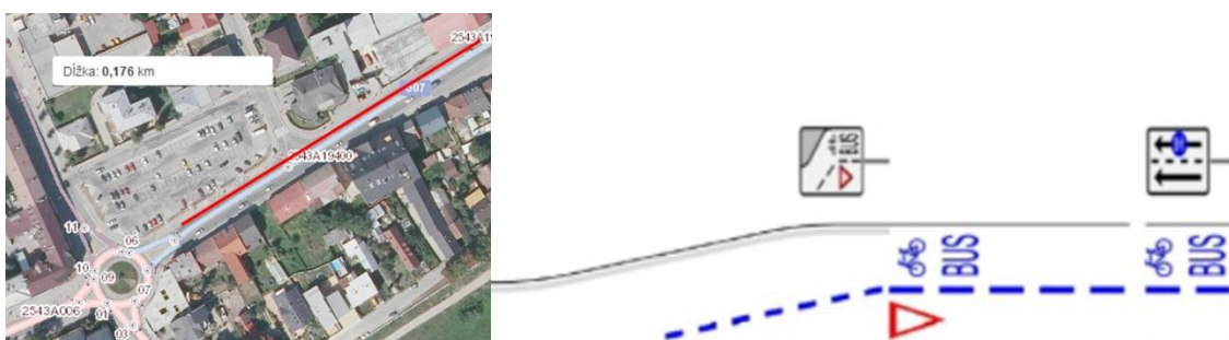
Obr. 6 Návrh vyhradeného jazdného pruhu na ul. Hollého (vľavo), odporúčanie úpravy prednosti v jazde v mieste ukončenia vyhradeného jazdného pruhu (vpravo) Zdroj: [10, 11]
