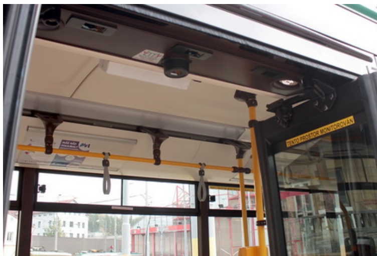
Obr. 4: Nenápadná instalace infračervených senzorů pro automatické počítání cestujících značky DILAX (tři obdélníkové ploché prvky s „okénkem“ v pohledu dveří)
